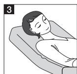
ヘッドレストに掛けた手をゆっくり離してシートを倒します。シートが後ろにふわりと倒されたら、プラス™システムは解除されています。
